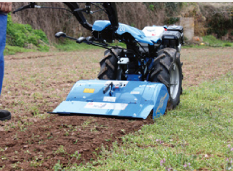
Aspecto posterior de la máquina en la que se aprecian los mandos de la caja de cambios y de la tdf y la regulación de profundidad.
