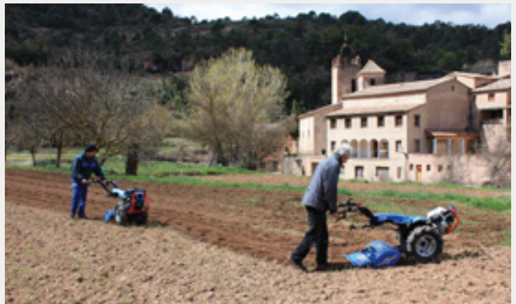
Ambos motocultores en pleno trabajo. Se puede apreciar el poco esfuerzo necesario para realizar el giro.
