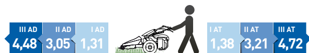
Gráfico velocidad en km/h con ruedas 5.0-10 / Gráfico de velocidade em km/h com rodas 5.0-10
