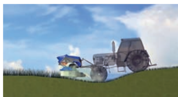
El sistema de autoaligeramiento dinámico de la Neva permite a la máquina "copiar" cualquier perfil del terreno manteniendo sus excepcionales cualidades de siega.
