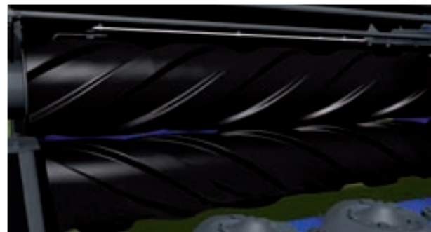
El acondicionador de doble rodillo de caucho acanalado (tipo Chevrons), constituye el sistema preferido por una gran parte de los cultivadores de forraje.
