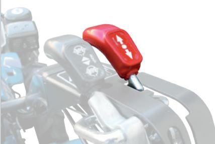
**Puesto de conducción:** confortable con los mandos situados de forma ergonómica. Las manecillas de conducción son regulables en altura, lateralmente y reversibles. El sistema de amortiguación "Silent-block" atenua las vibraciones producidas por la máquina al trabajar.
